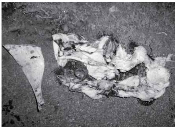
▲ポンプに流入した異物
