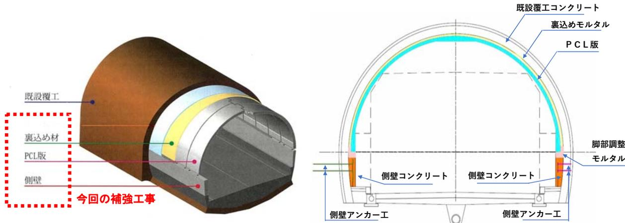
※側壁コンクリートが完成して、1月20日よりPCL版を設置します。
